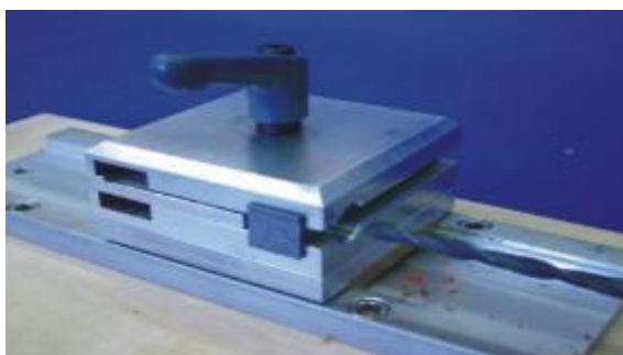
obr. 15 Vrtání otvoru do hranolu
