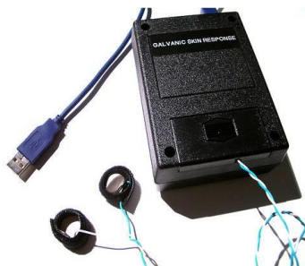
Obrázek 2. Jednoduchý přístroj na snímání EDA (převzato z http://wikid.eu/index.php/File:Setup.jpeg )
