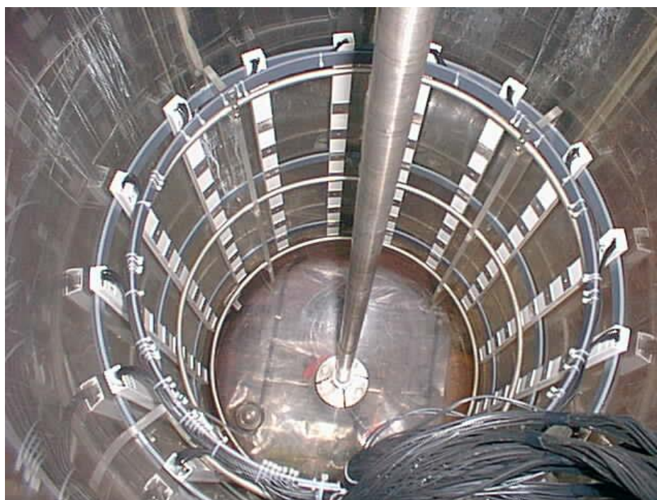
Obr. 1.3: Uspořádání elektrod pro měření tomografem
