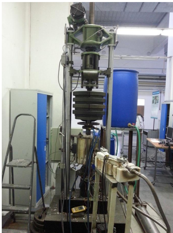
Obr. 21: vysokofrekvenční pulzátor ve firmě COMTES FHT s osazenou komorou pro zkoušky při zvýšené teplotě
