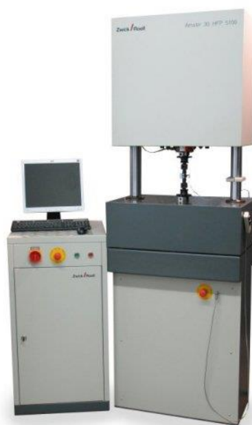
Obr. 19: vysokofrekvenční pulzátor Amsler 30 HFP 5100 (fy Zwick Roell) [7]
