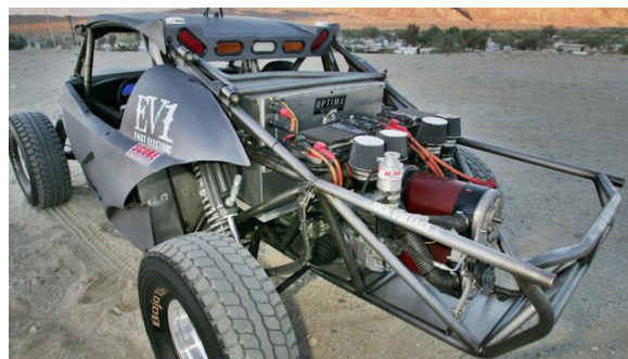
Obrázek 20 SRI EV1 Buggy - pohonné ústrojí [32]
