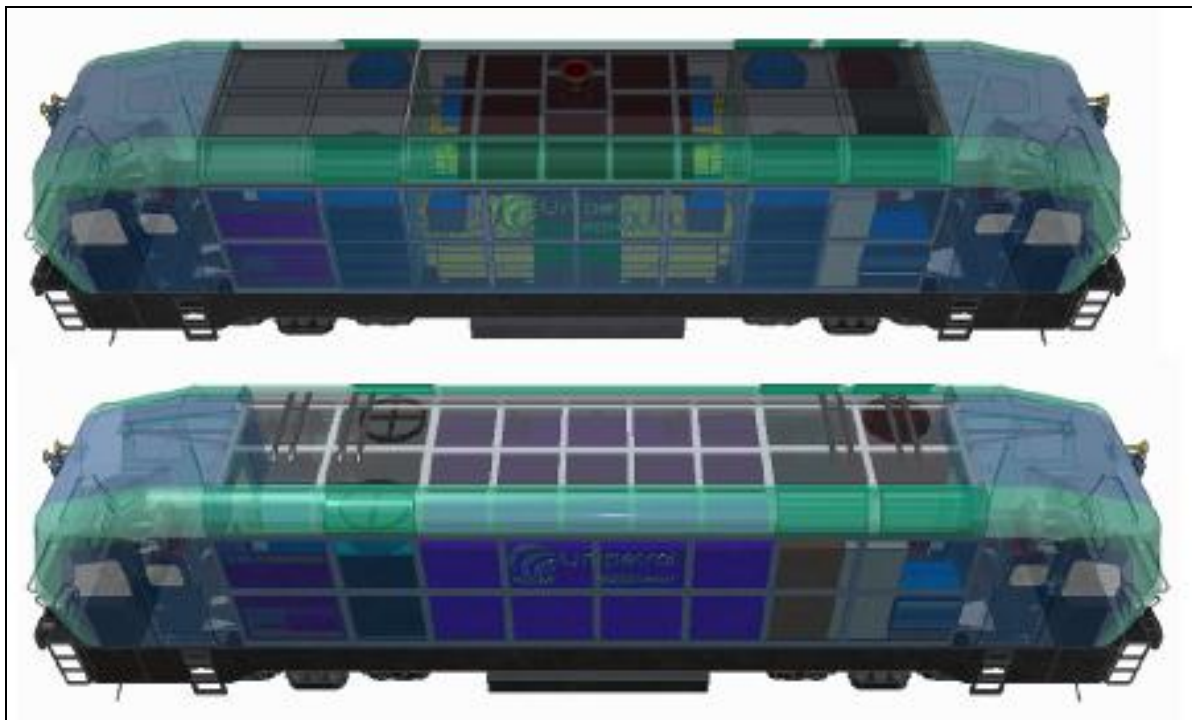
Obrázek 80 - Hrubá stavba skříně
