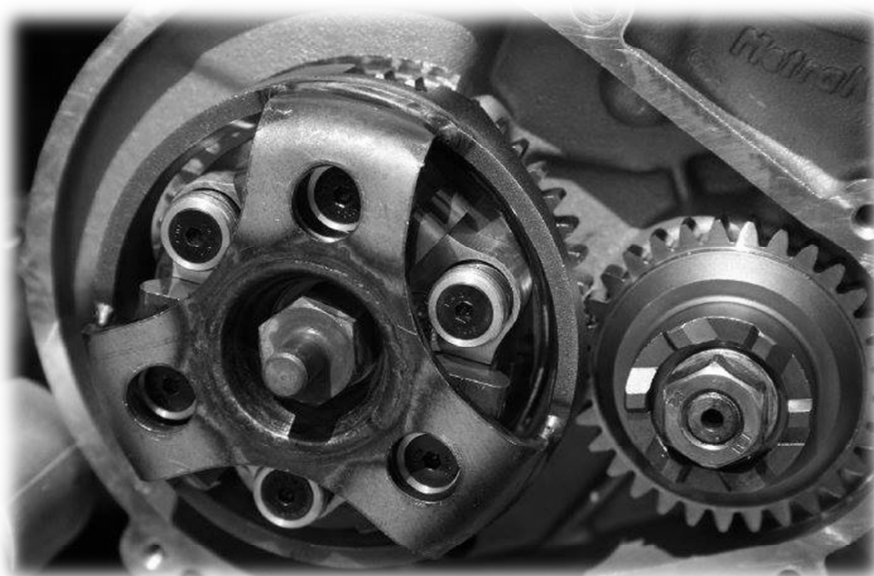
Obrázek 2-8: Pohled na primární převod a spojku motoru Metrakit MKX 50 [12]
