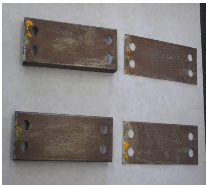
Obr.č.57: Rozsah koroze vzorků č.4.1, č.5.1, č.6.1, č.7.1 po očištění od korozních zplodin_hodnocení č.3
