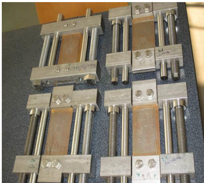
Obr.č.54: Rozsah koroze vzorků č.1.1, č.2.1, č.3.1, č.8.1 po očištění od korozních zplodin_hodnocení č.2
