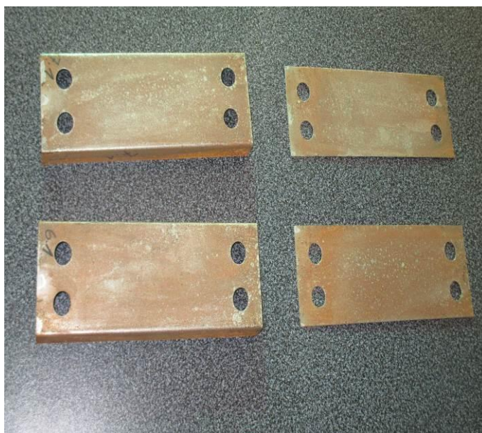
Obr.č.55: Rozsah koroze vzorků č.4.1, č.5.1, č.6.1, č.7.1 po očištění od korozních zplodin_hodnocení č.2
