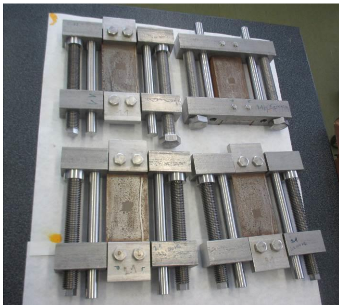
Obr.č.56: Rozsah koroze vzorků č.1.1, č.2.1, č.3.1, č.8.1 po očištění od korozních zplodin_hodnocení č.3
