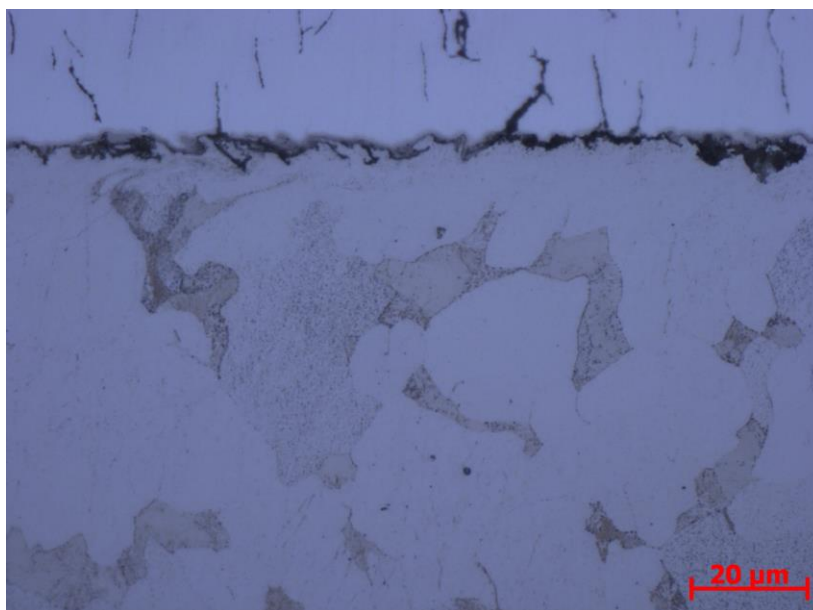
Obr. 35.: Přechod mezi základním materiálem a povlakem chromu u nitridace v plynu
