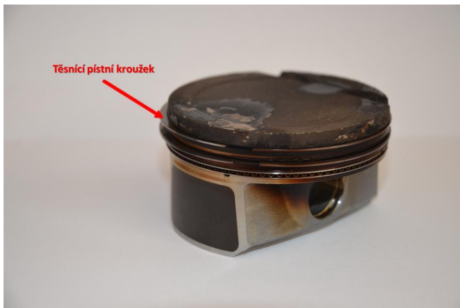
Obr. 16.: Píst se skupinou pístních kroužků po zkoušce životnosti
