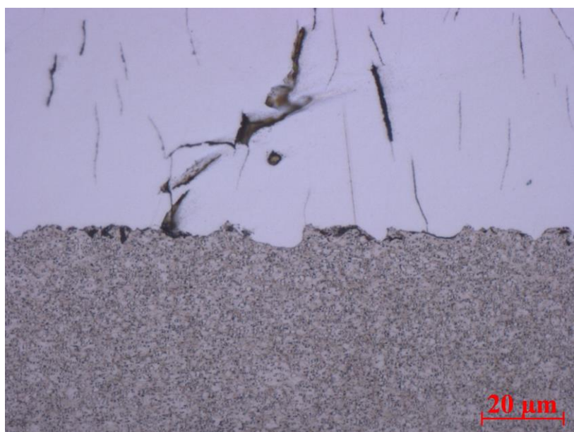
Obr. 41.: Přejech základního materiálu a povlaku po iontové nitridaci
