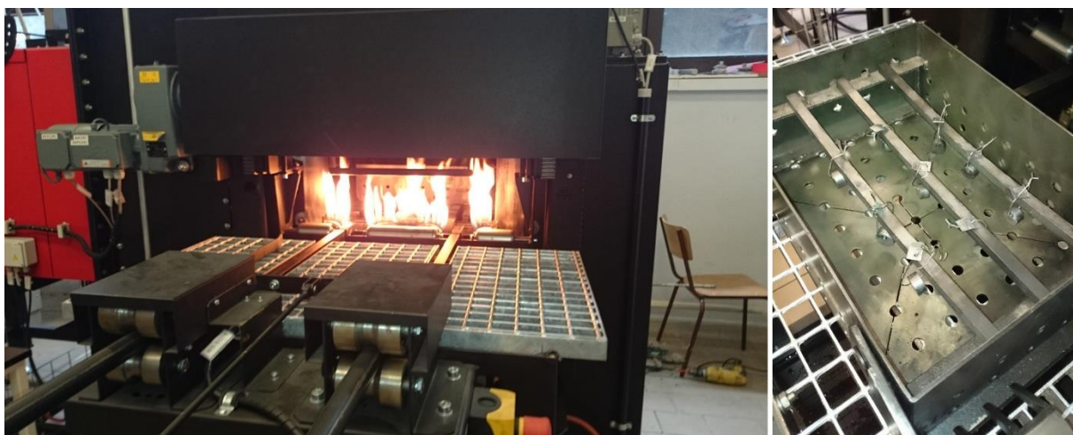
Obr. 6.2-2 Vlevo – předkomora cementační pece s otevřenými dveřmi, vpravo - rozmístění vzorků v koši
