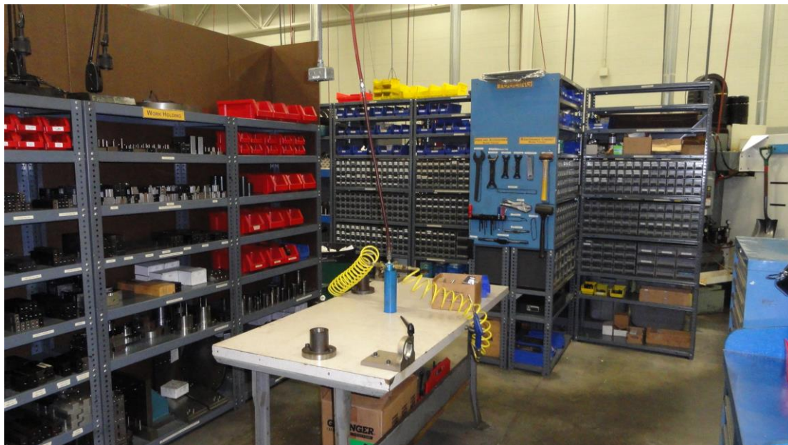
Obr. 10 - Příklad pracoviště po zavedení metody 5S [49]
