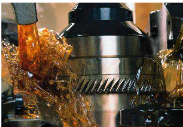
Obr. 2.6: Chlazení řezným olejem při frézování [21].
