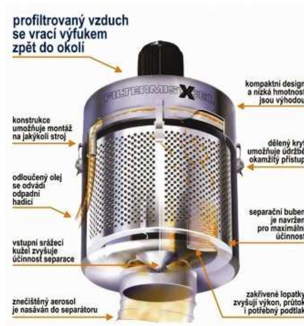
Obr. 5.3: Princip filtračního zařízení
