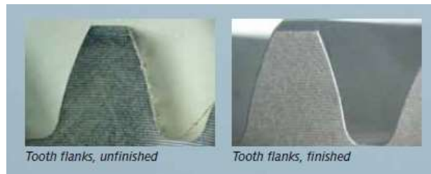
Obr. 2.6: Bok zubů před a po proudovém omílání [21]
