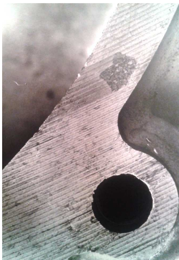
Obrázek 7: Oxidický vměstek tvrdší než okolní materiál, otupení je patrné z charakteru obrobení plochy před a za vměstkem
