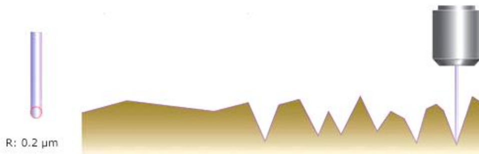
Obr. 2.2-6 Měření mikronerovnosti laserem [17]
