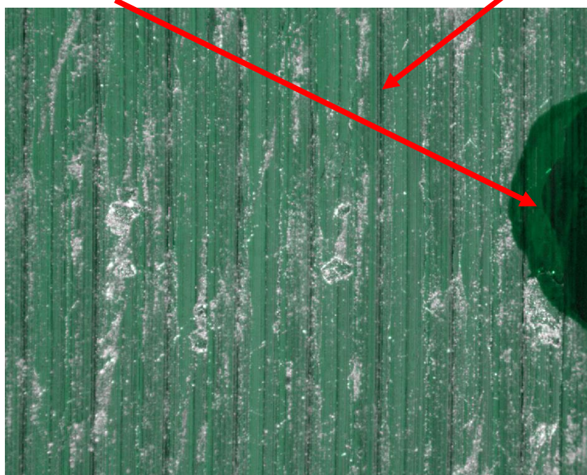
Obr. 4.3-2 Nasnímaný povrch vzorku 3A objektivem 10x
