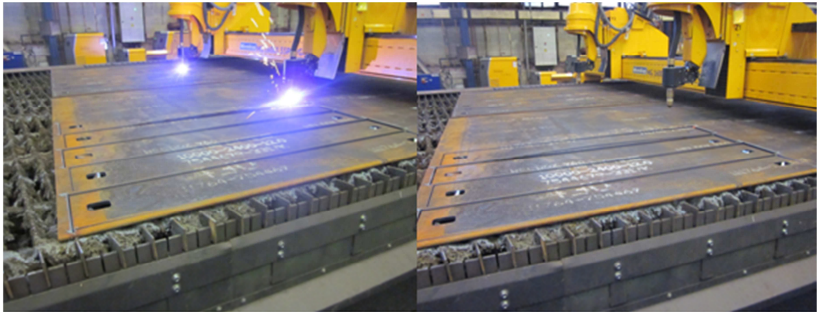
Obr. 4-6 Zdvih okrajového materiálu na plazmovém stroji
