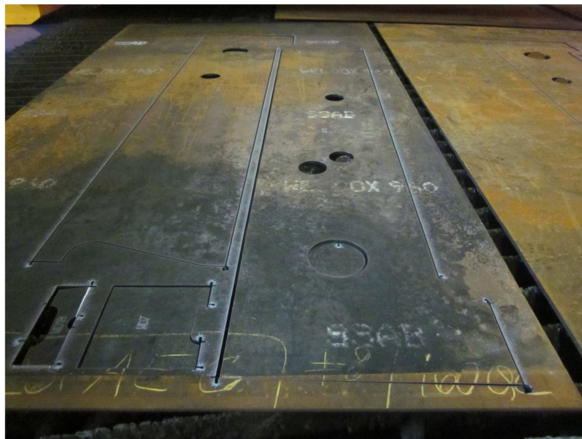
Obr. 4-15 Typové dílce, kde vzniká odskok
