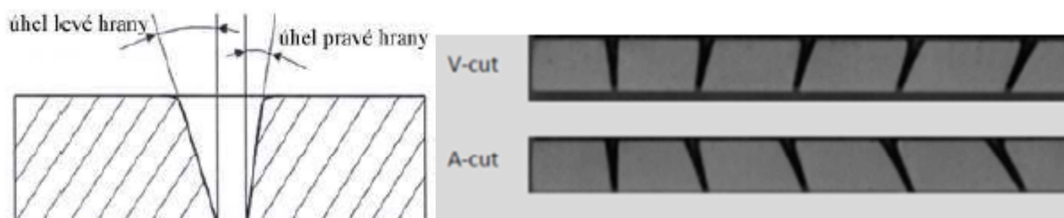
Obr. 3-4 Úhlové odchylky při pálení pod úhlem [2]
