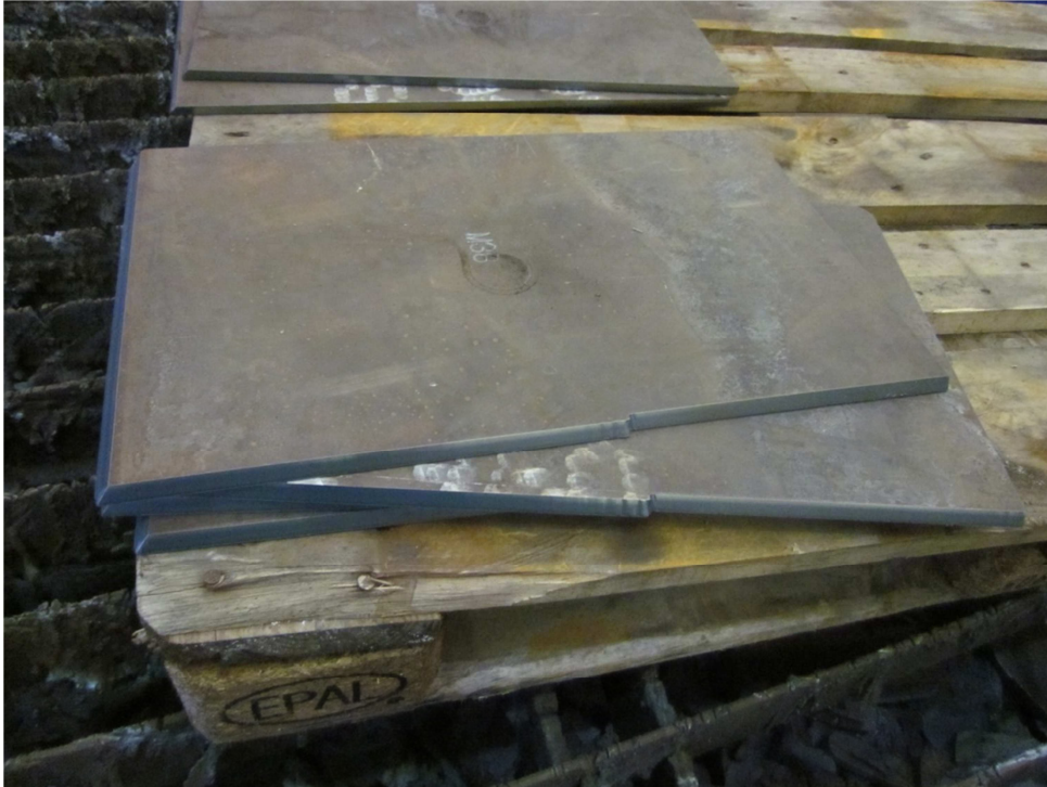
Obr. 1-6 Dílec se schodovitou výrobní vadou
