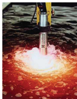
Obr. 2-4 Řezání pod vodou [21]
