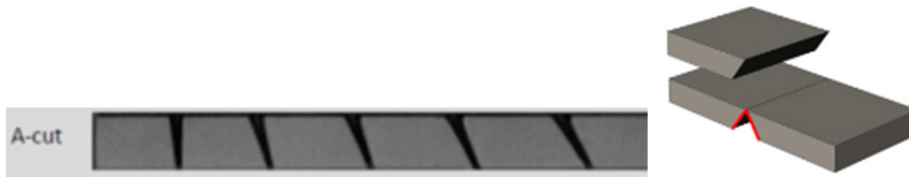
Obr. 5-14 Zaoblení výpalku u zkosení typu A [2]
