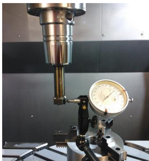
Obr. 4.7. Měření házivosti u RC upínacího systému
