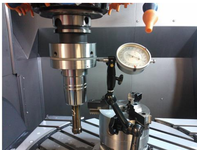
Obr. 4.7. Měření házivosti u RC upínacího systému
