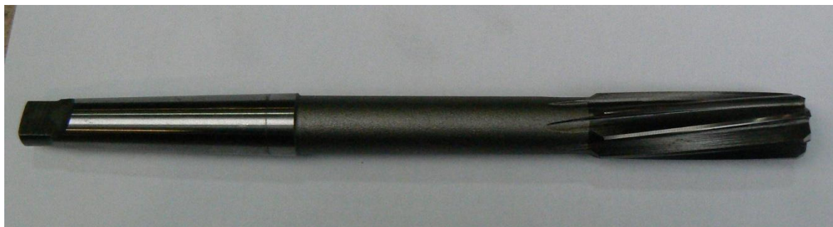
Obr. 3.4. HSS výstružník používaný v GTW BEARINGS
