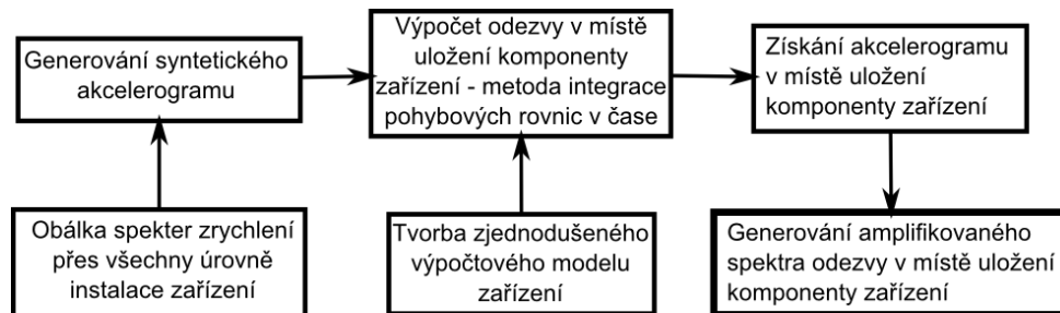
Obrázek 1: Postup při generování amplifikovaného spektra odezvy v místě uložení komponenty zařízení
