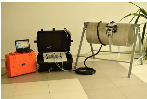
(a) Sestava manipulátoru a mobilního rozvaděče
