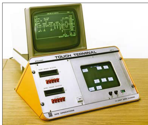
Obr. 3 – prvý kapacitný dotykový displej; zdroj: http://cerncourier.com/cws/article/cern/42092
