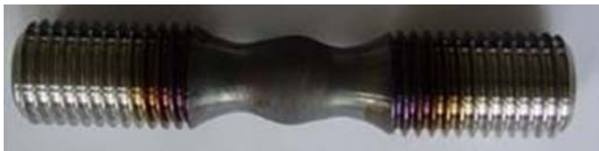
Obr. 3. Zkušební těleso po termomechanickém zpracování
