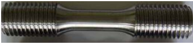
Obr. 2. Zkušební těleso s průměrem aktivní části 8 mm v počátečním stavu
