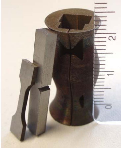
Obr. 4. Zkušební tělesa pro mechanické zkoušky odebrané po TMZ, minitahovka 1,2x2mm
