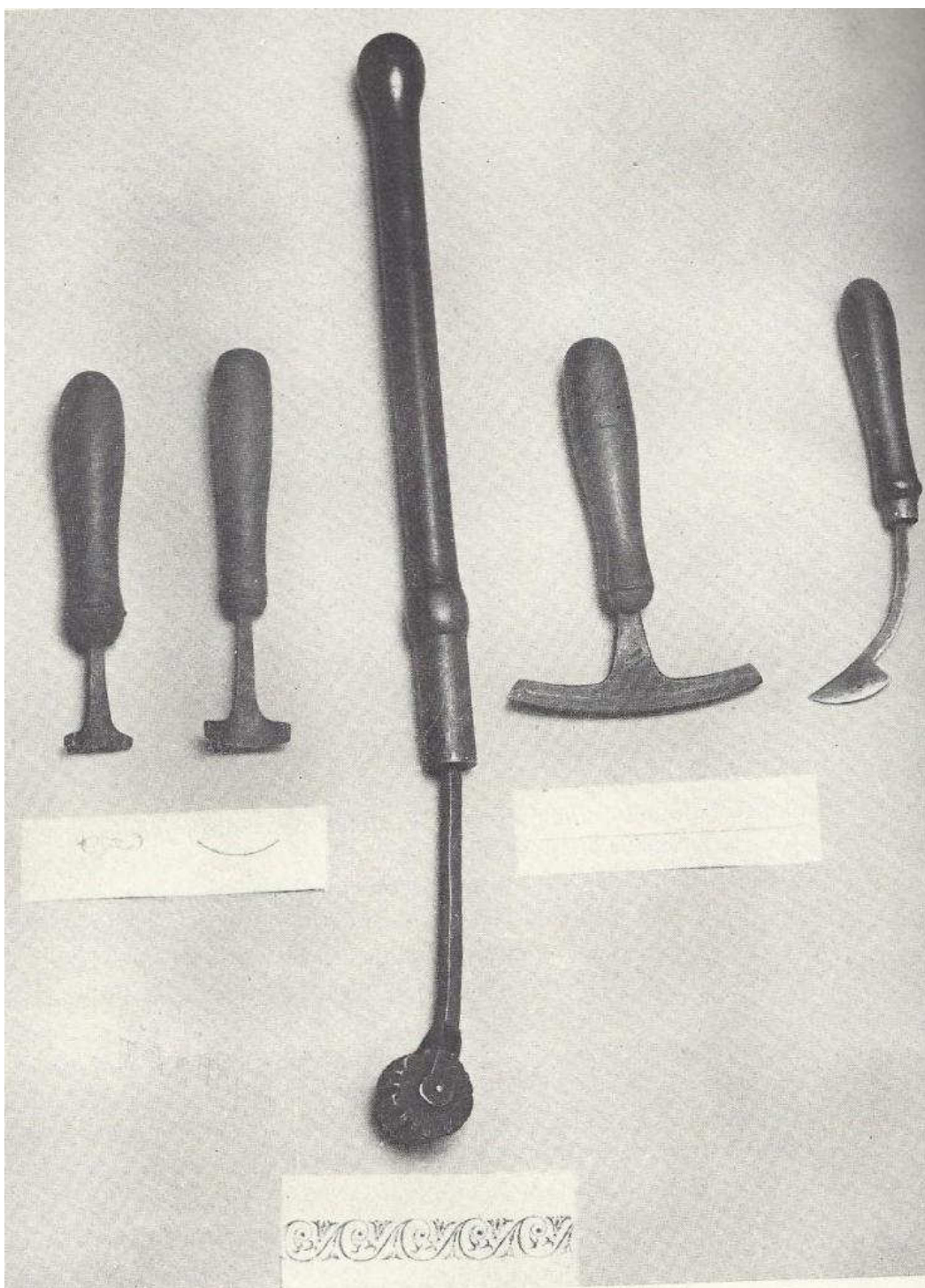
Příloha č. 12. Knihařské nástroje užívané k výzdobě knihy (zleva): kolek, oblouček, váleček, fileta, čárkováno. Kopie z knihy: Hamanová, P. Z dějin knižní vazby . [Česko] : P. Hamanová, 1959, s. 175.
