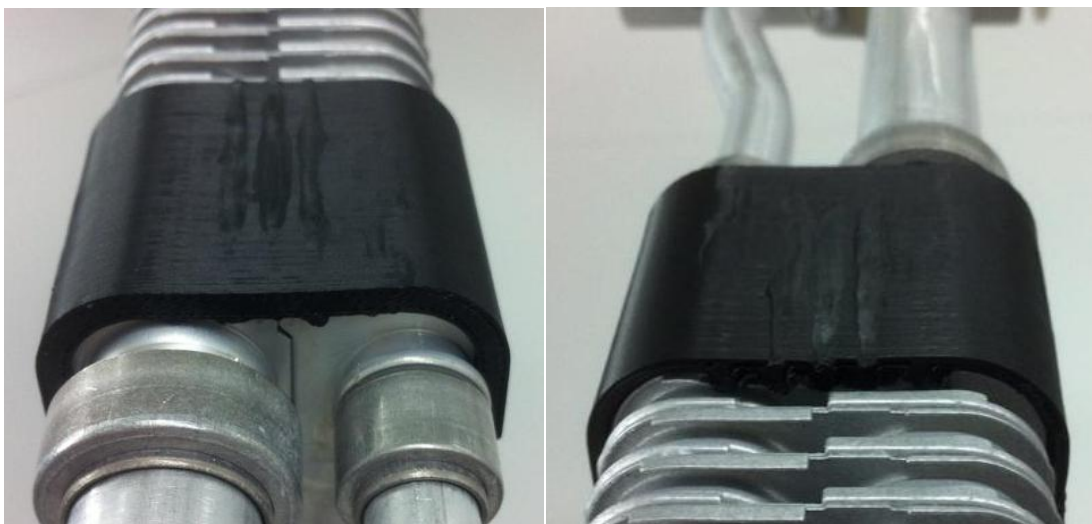
Obrázek č. 20 Výparník s plastovým krytem
