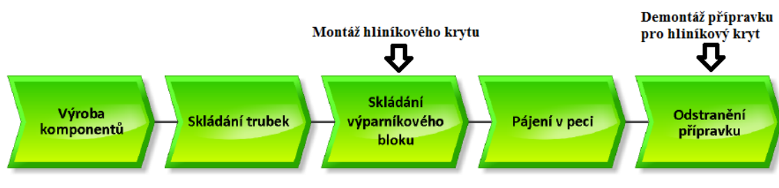
Obrázek č. 43 Stávající stav nasazování hliníkového krytu
