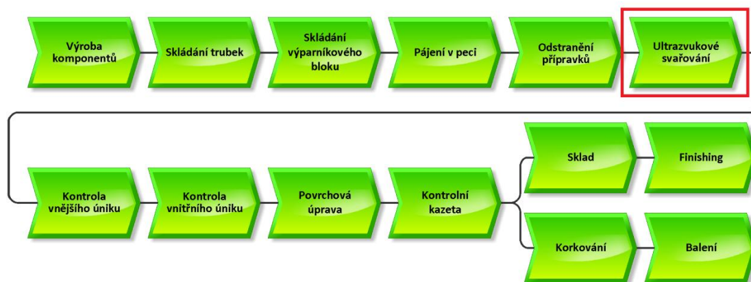
Obrázek č. 47 Návrh implementace ultrazvukového svařování I.
