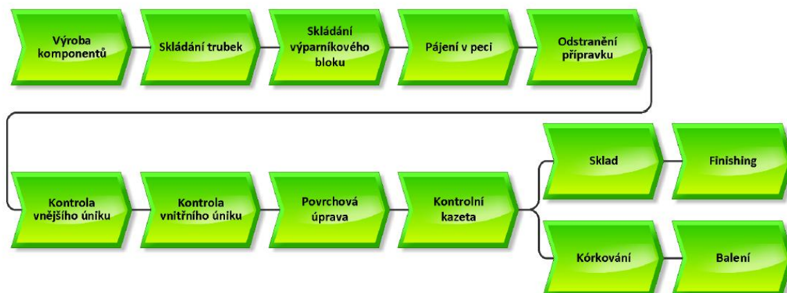
Obrázek č. 41 Schéma jednotlivých kroků výroby výparníkového bloku
