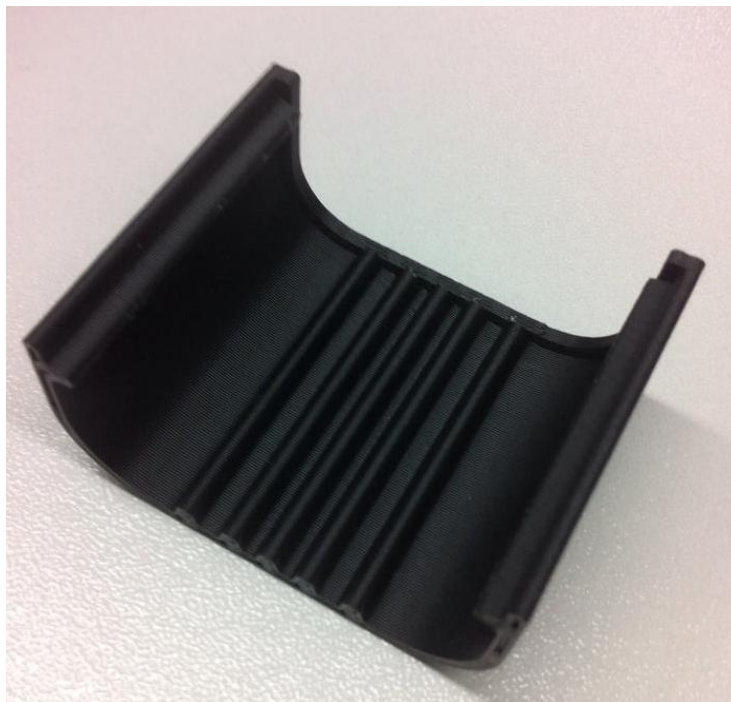
Obrázek č. 19 Vytisknutý plastová kryt V.01
