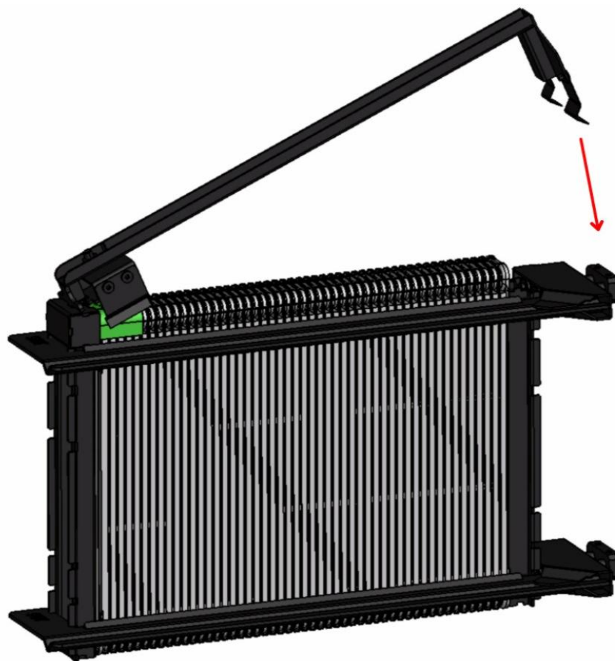
Obrázek č. 45 Nasazení třetího céčka
