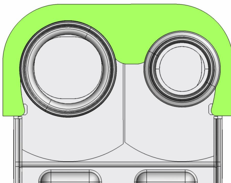
Obrázek č. 39 3D model sestavy výparníkového bloku s plastovým krytem verze 6
