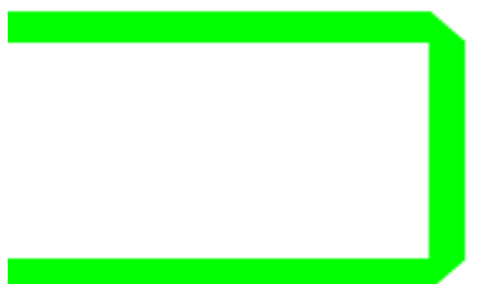
Obr. 6.8 Mikropáskové vedení - zkosené hrany
