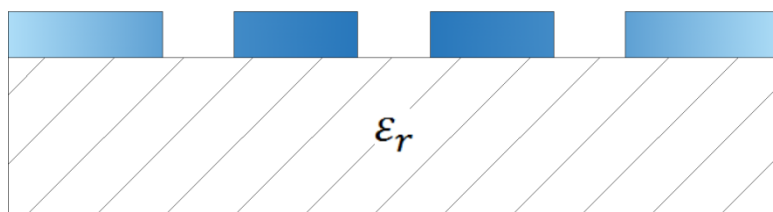
Obrázek 12 Vázaný koplanární vlnovod
