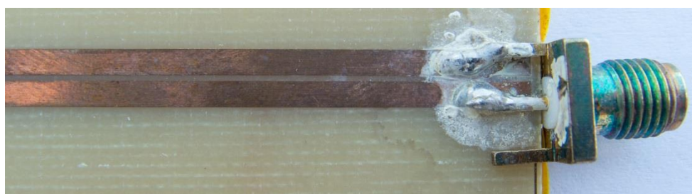
Obr. 7.10 Koplanární vedení 100 \Omega
