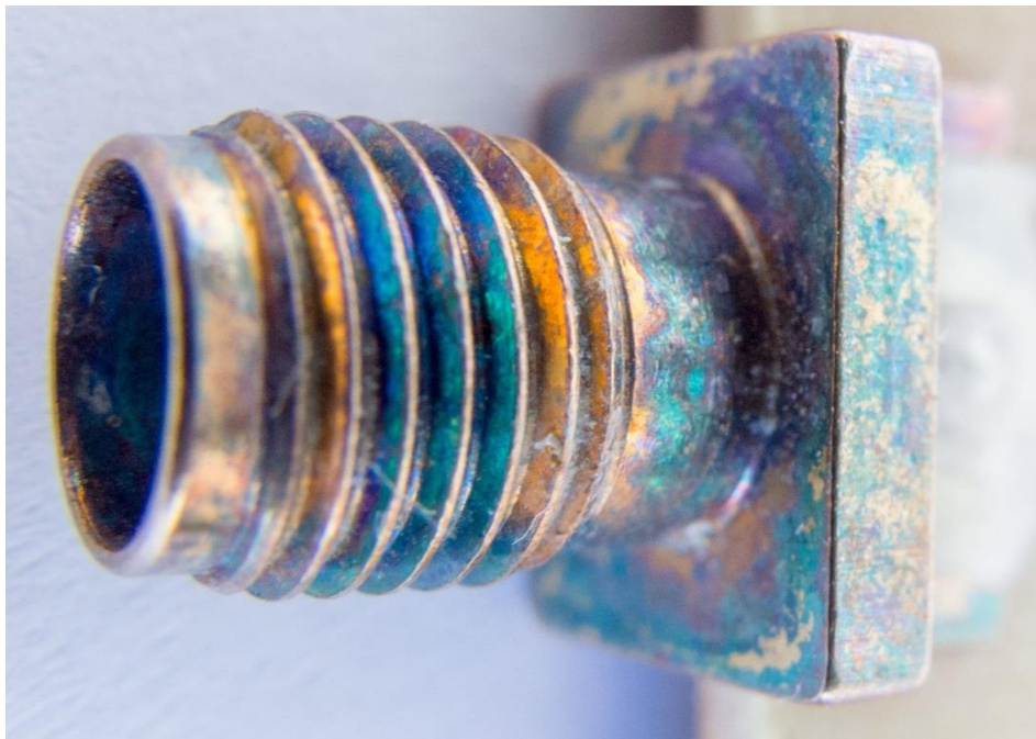
Obr. 7.3 Oxidace SMA konektoru
