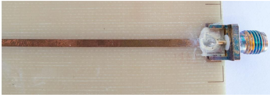
Obr. 7.2 Mikropáskové dlouhé vedení
