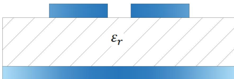
Obrázek 10 Vázané mikropáskové vedení
