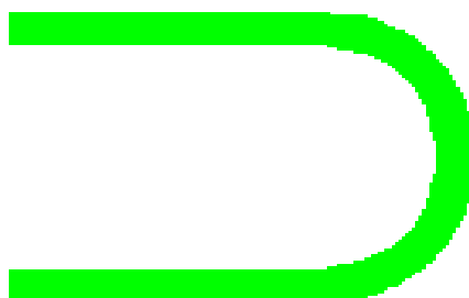
Obr. 6.7 Mikropáskové vedení - větší zaoblení hran
