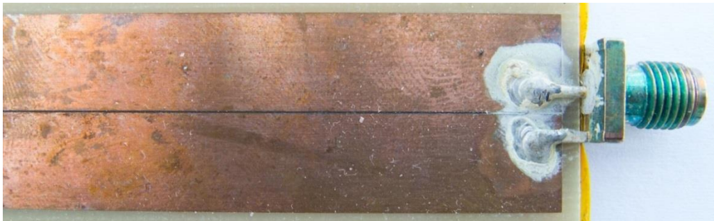
Obr. 7.9 Koplanární vedení 67 \Omega
