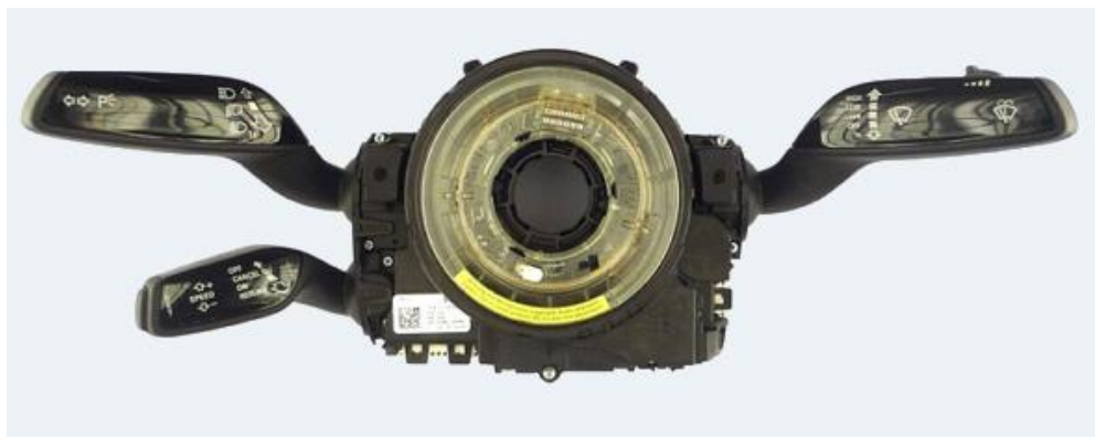
Obr.3 Podvolantový řídicí modul pro AUDI
