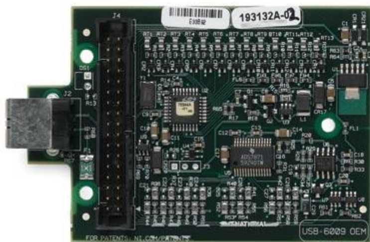
Obr.10 NI modul typ OEM. Je otevřený a obsahuje patici díky které je možno modul připojit přímo k převodní elektronice.
