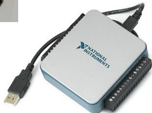
Obr.18 NI 6008. Je uzavřený v krabičce a připojení je řešeno šroubovými svorkami.
