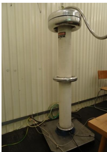
Obr. 3-5: Vazební jednotka a náhradní schéma snímání impedance
