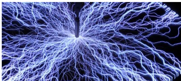
Obr. 1-4: Ukázka klouzavého výboje na pevném izolantu
