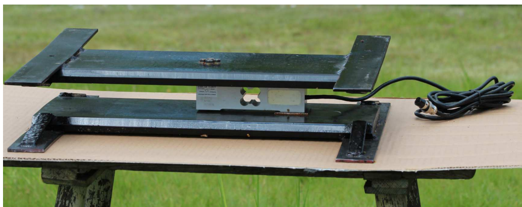
Obr. 16: Ocelová konstrukce váhy s namontovaným tenzometrem.
