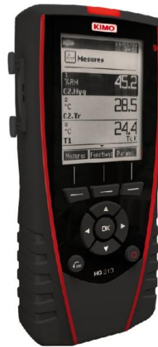
Obr. 1 Přístroj pro měření parametrů okolního prostředí KIMO HQ210 [3]
