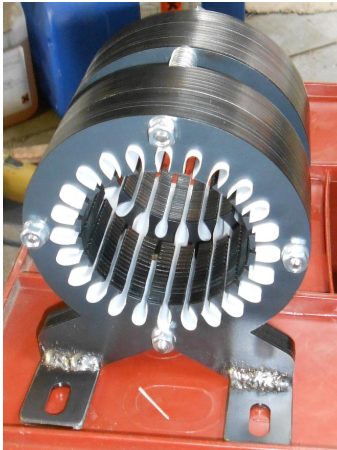
Obr. 3.2 stator s doplňkovou izolací
