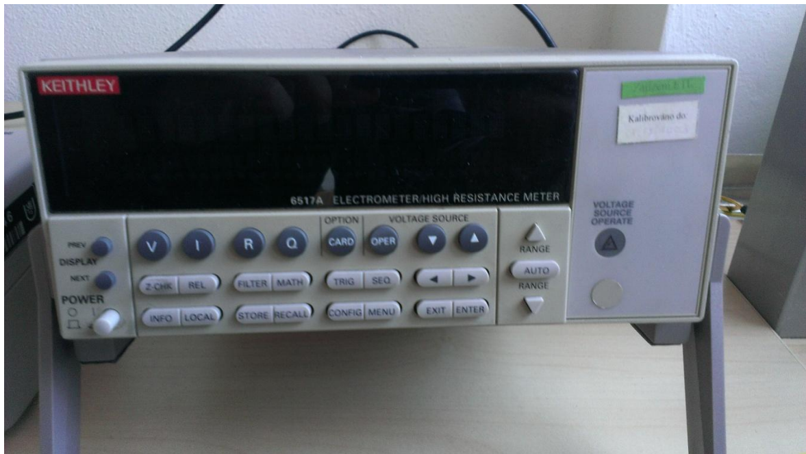
Obr. 18: Ampérmetr Keithley 6517A pro měření malých proudů izolantem
