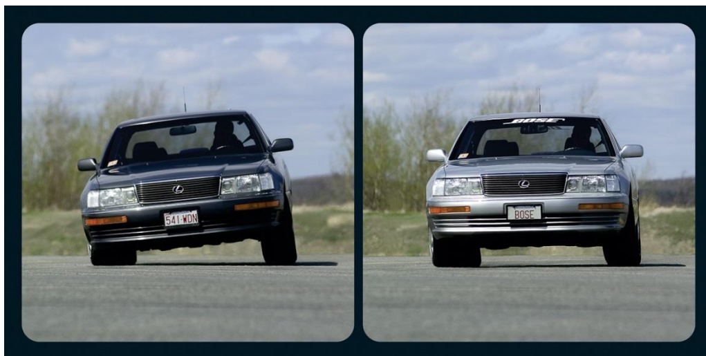
Obr. 17 Porovnání chování vozidla při průjezdu zatáčkou. Vlevo vozidlo s využitím konvenčního tlumení a vpravo vozidlo využívající systém tlumení Bose. (převzato z [6])
