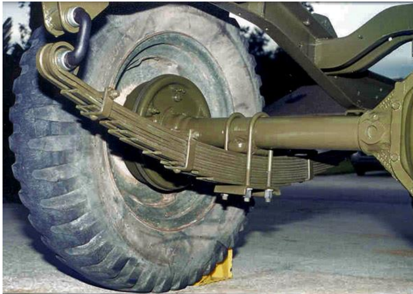
Obrázek 2: Listová semi-eliptická pružina[15]
