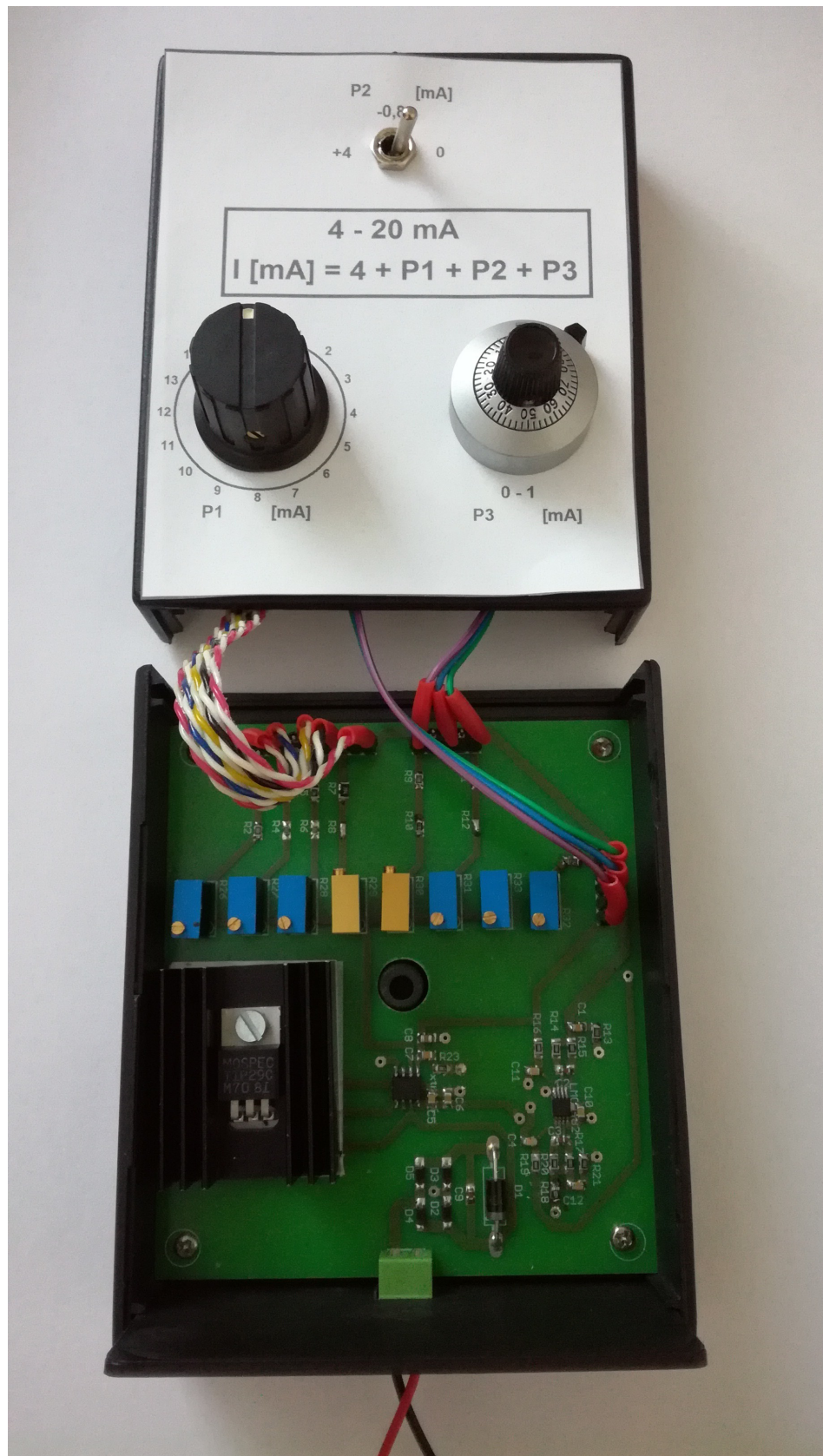
Příloha G: Kalibrační vysílač proudové smyčky
