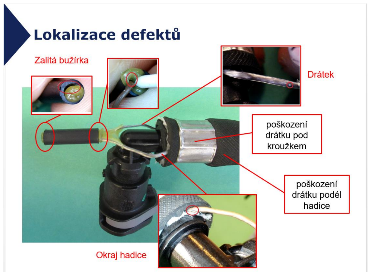
Obr. 3.1 Příklad defektů, které se objevovaly na hadici.
