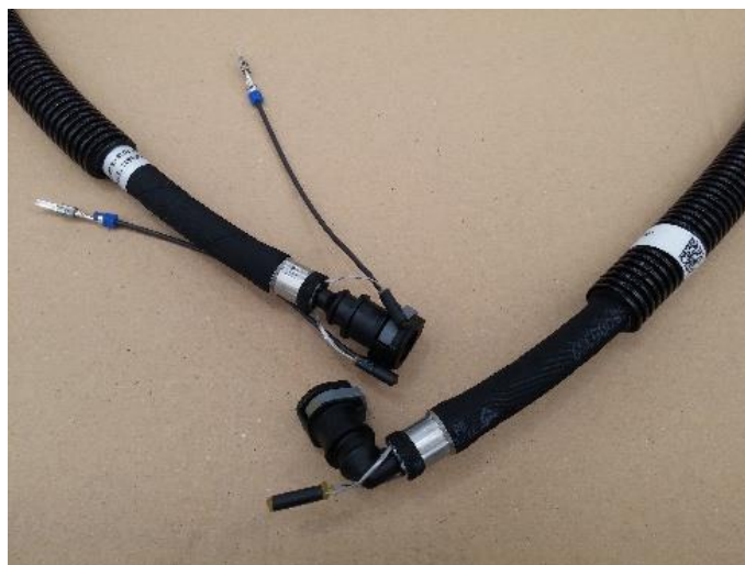
Obr. 2.3 konce hadice po vodním testu.
