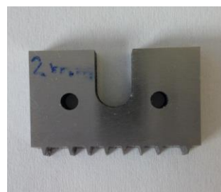
Obr. 5.8 - speciální řezací nůž, osm břitů, postranní bříty slouží ke stabilizaci
