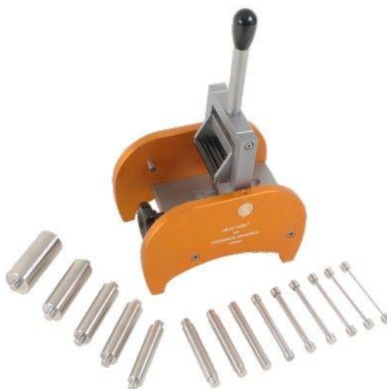
Obr. 4.5 - Cylindrický trn se sadou trnů o různém průměru, (převzato z [36])
