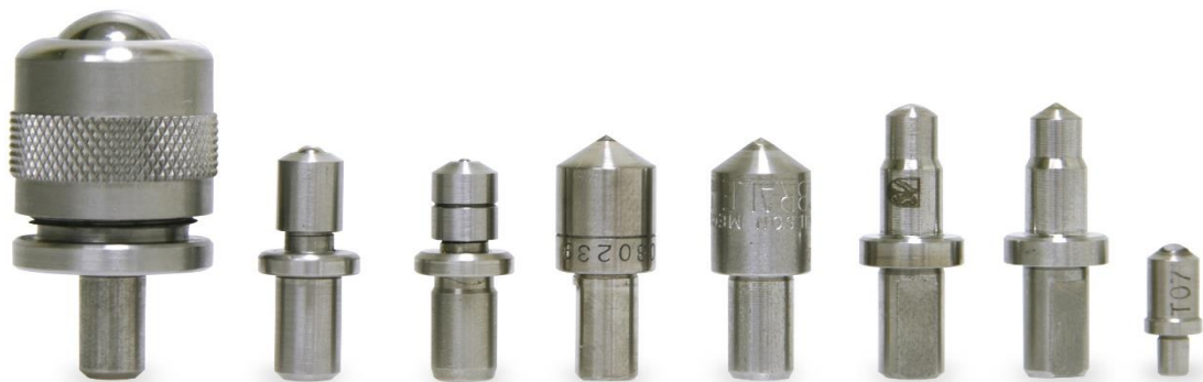
Obr. 4.3 - Příklady typů indentorů, Rockwellův kužel čtvrtý zleva (převzato z [23])
