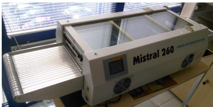
Obr. 3.4 Horkovzdušná přetavovací pec Mistral 260
