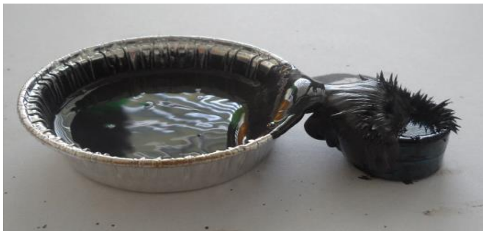
Obrázek 1.3 Magnetoreologická kapaliny vystavená magnetickému poli [převzato z 8]
