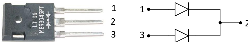
Obr 2.11 Pouzdro a obsazení konektorů MBR3045
