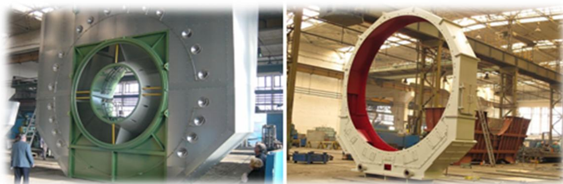
Obr. č. 5: Sací kanál pro plynovou turbínu a ložiskový domek mlýnice
