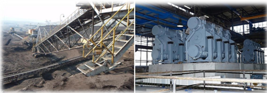
Obr. č. 7: Vynášecí most pro dopravu uhlí, mlýny pro drcení uhlí na multiprachech
