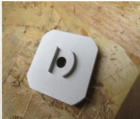
Obrázek 21: Díl po pískování
