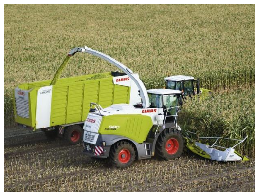
Obr. č. 2.: Sklízecí řezačka Claas typu JAGUAR 950 Profistar
