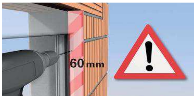
Obrázek 89: Zobrazení minimální vzdálenosti okna od líce zdiva
