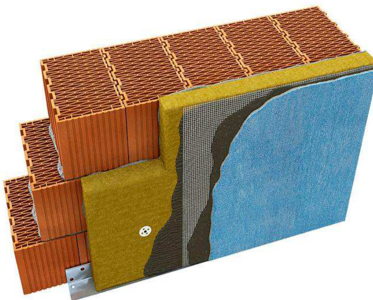
Obrázek 31: Skladba kontaktního zateplení pomocí minerální vaty [31]
