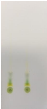
Obrázek 72: dělení barviv listů špenátu, před filtrací (na silufolu)
