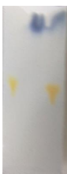
Obrázek 42: chromatogram po ponoření do par amoniaku (zleva methylčerveň, thymolová modř, směs)
