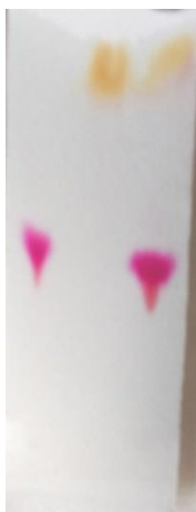
Obrázek 41: chromatogram po ponoření do par chlorovodíku (zleva methylčerveň, thymolová modř, směs)
