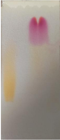
Obrázek 50: chromatogram po ponoření do par chlorovodíku (zleva methyloranž, thymolftalein, thymolová modř, univerzální indikátor Čůta – Kámen)
