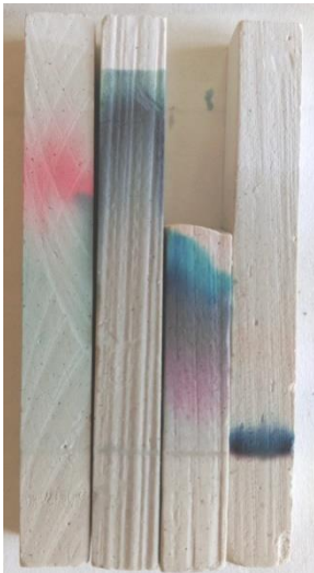
Obrázek 14: černý fix Koh-I-Noor Hardmuth (použitá rozpouštědla zleva: voda, methanol, ethanol, aceton)
