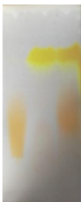
Obrázek 48: chromatogram po ponoření do par chlorovodíku (zleva methyloranž, fluorescein, jejich směs)
