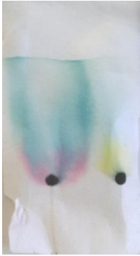
Obrázek 17: zleva: černý fix Koh-I-Noor Hardtmuth, černý fix Centropen; filtrační papír byl při vyvíjení srolovaný do ruličky
