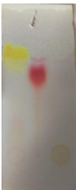
Obrázek 52: chromatogram po ponoření do par chlorovodíku (zleva fluorescein, methylčerveň, univerzální indikátor Čůta – Kámen)
