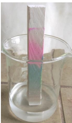
Obrázek 9: dělení barev v modrém fixu (Koh-I-Noor Hardtmuth)
