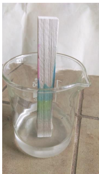
Obrázek 10: dělení barev v zeleném fixu (Koh-I-Noor Hardtmuth)
