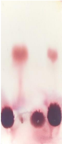
Obrázek 82: chromatogram aminokyselin (zleva L-lysin, glycin, L-cystein, směs)
