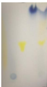
Obrázek 45: chromatogram po ponoření do par amoniaku (zleva methyloranž, thymolftalein, methylčerveň, thymolová modř, směs)
