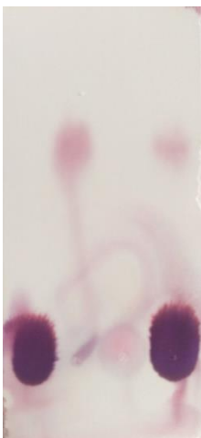
Obrázek 83: chromatogram aminokyselin (zleva L-lysin, glycin, L-cystein, směs), opomenuté vysušení
