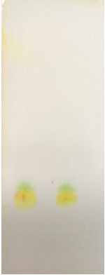
Obrázek 61: výsledný chromatogram (případ 1), listy špenátu, (v chromatografické komoře byly vytvořeny vrstvy rozpouštědel)
