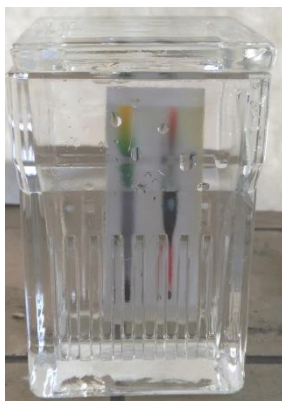
Obrázek 5: vyvíjení látek na fixované vrstvě adsorbentu v chromatografické komoře
