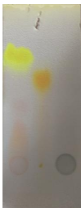
Obrázek 53: chromatogram po ponoření do par amoniaku (zleva fluorescein, methylčerveně, univerzální indikátor Čůta – Kámen)
