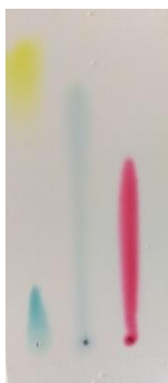
Obrázek 55: výsledný chromatogram (zleva zelené barvivo, modré barvivo, červené barvivo), rozpouštědlo: 0,5% roztok NaCl
