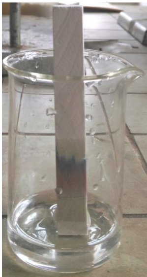
Obrázek 7: dělení barev v hnědém fixu (Koh-I-Noor Hardtmuth)
