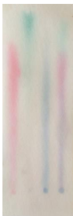
Obrázek 33: výsledný chromatogram – filtrační papír (zleva: červená, zelená a modrá barva, směs barev)
