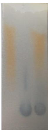
Obrázek 39: chromatogram po ponoření do par amoniaku (zleva methyloranž, thymolftalein, směs)
