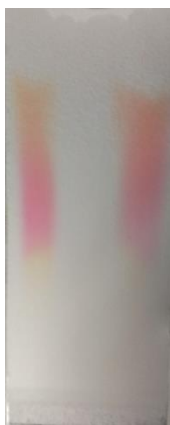
Obrázek 38: chromatogram po ponoření do par chlorovodíku (zleva methyloranž, thymolftalein, směs)
