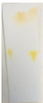
Obrázek 43: chromatogram po 12 minutách (zleva methylčerveň, thymolová modř, směs)
