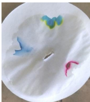
Obrázek 57: výsledný chromatogram (zleva modré barvivo, zelené barvivo, červené barvivo), rozpouštědlo: destilovaná voda
