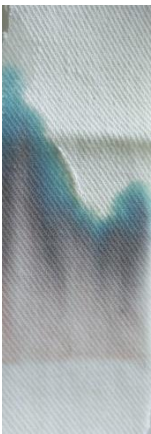
Obrázek 26: černý fix (Koh-I-Noor Hardtmuth) – rozpouštědlo: voda
