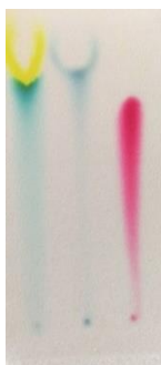
Obrázek 56: výsledný chromatogram (zleva zelené barvivo, modré barvivo, červené barvivo), rozpouštědlo: destilovaná voda
