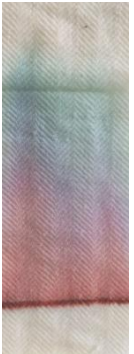
Obrázek 25: hnědý fix (Koh-I-Noor Hardtmuth) – rozpouštědlo: ethanol
