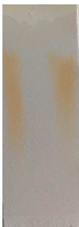
Obrázek 40: chromatogram po 1 minutě (zleva methyloranž, thymolftalein, směs)
