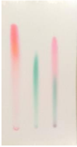
Obrázek 35: výsledný chromatogram – silufol (zleva: červená a zelená barva, směs barev), rozpouštědlo: destilovaná voda
