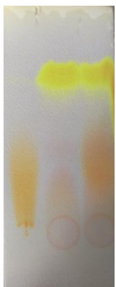
Obrázek 49: chromatogram po ponoření do par amoniaku (zleva methyloranž, fluorescein, jejich směs)
