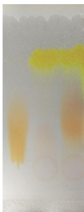
Obrázek 47: chromatogram po vyjmutí z chromatografické komory (zleva methyloranž, fluorescein, jejich směs)
