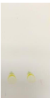
Obrázek 63: výsledný chromatogram (případ 3), (odlila jsem část ze směsi rozpouštědel a tuto část jsem použila pro vyvíjení destičky)
