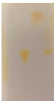
Obrázek 46: chromatogram po 16 minutách (zleva methyloranž, thymolftalein, methylčerveň, thymolová modř, směs)
