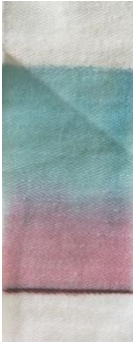
Obrázek 24: černý fix (Koh-I-Noor Hardtmuth) – rozpouštědlo: ethanol
