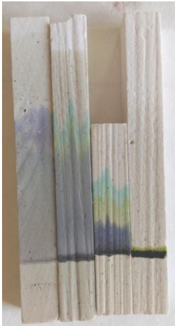
Obrázek 13: černý fix Centropen (použitá rozpouštědla zleva: voda, methanol, ethanol, aceton)
