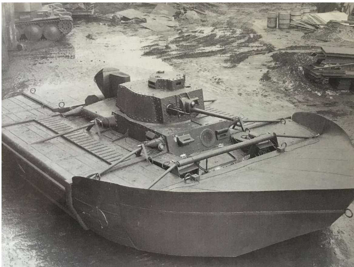
Obrázek 9 - PzKpfw 38(t) s nasazeným plovákem AP-1 (zdroj: PEJČOCH, Ivo. Lehké tanky: dějiny vývoje a nasazení lehkých tanků od první světové války do současnosti . Vyd. 1. Cheb: Svět křídel, 2012. Svět křídel. ISBN 978-80-87567-18-0 s. 77.)
