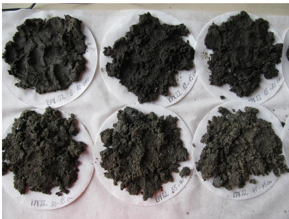
Obrázek č. 11 Jednotlivé segmenty vrtu schnoucí při pokojové teplotě na filtračním papíře.
