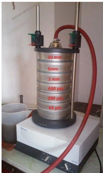
Obrázekč. 12: Třepačka Retsch AS 200 basic s vyznačením velikosti ok jednotlivých sít.
