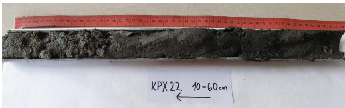
Obrázek č. 8: Popsané jádro v plastové formě (označení jádra dle místa odběru, šipka směřující k bázi a hloubka, ve které byl odběr realizován).
