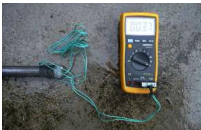
Obr. 7. Digitální měřicí přístroj Mastech MS8215.
