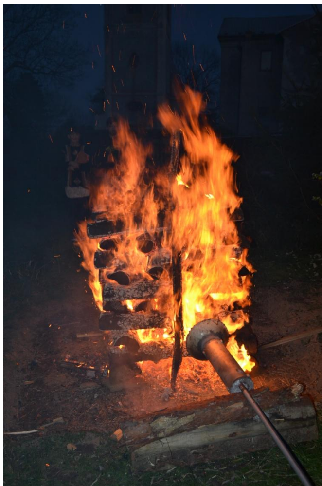
Obr. 8. Pozice měřicího systému v hořící hranici.
