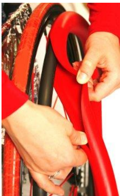
Obrázek 8 Gumový potah na poháněcí obruč
