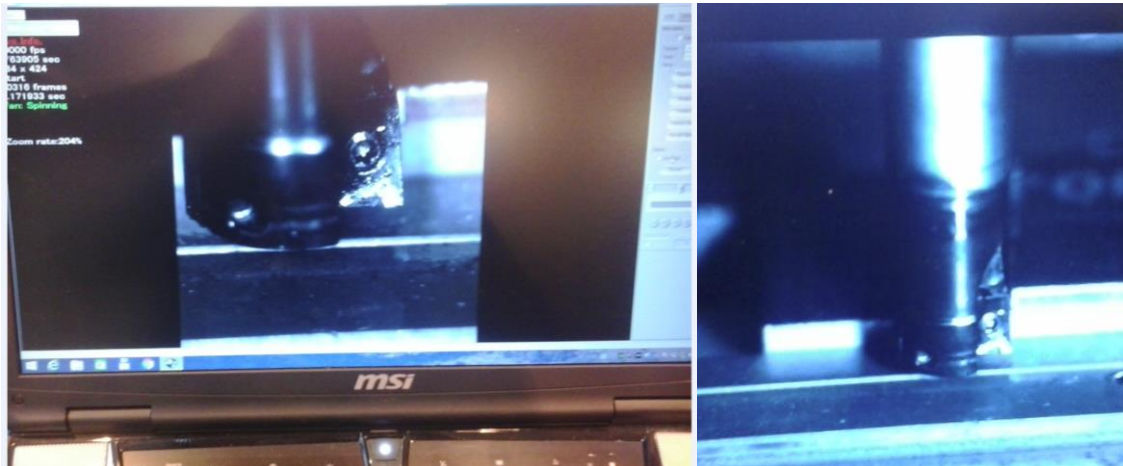
Obrázek 39 – Záznam vysokorychlostní kamery, která nahrávala odchod třísky
