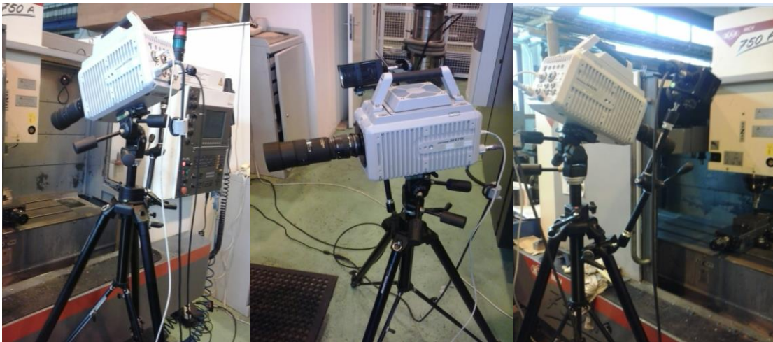
Obrázek 37 – Příprava vysokorychlostní kamery pro záznam řezu
