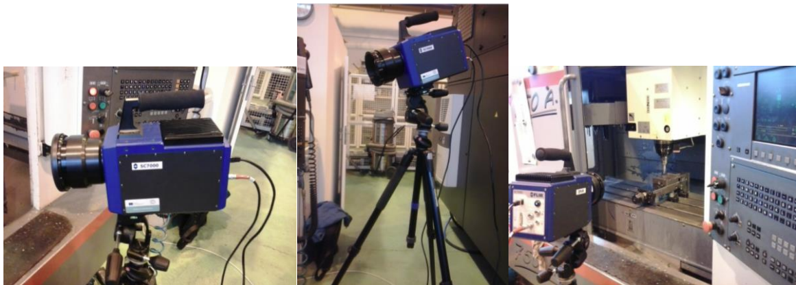
Obrázek 40 – Termovizní kamera nasměrovaná na místo řezu
