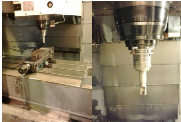
Obrázek 24 – Upnutí hydraulického upínače do MCV stroje
