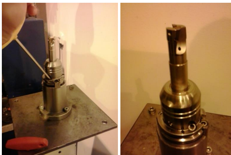
Obrázek 23 – Upnutí frézy do hydraulického upínače
