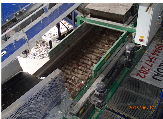
Obr. 12: Kritický stav hvězdicových sít
