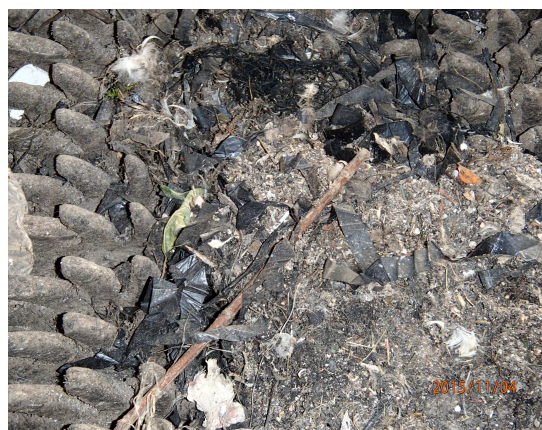
Obr. 11 Znečištěné hvězdice (Starscreen)
