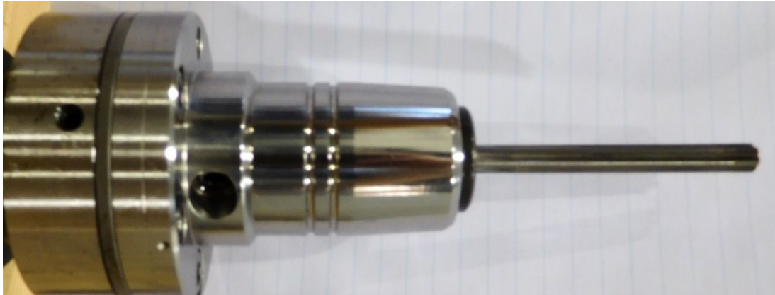
Obrázek 37 – Výstružník upnutý v RC seřizovací hlavici.
