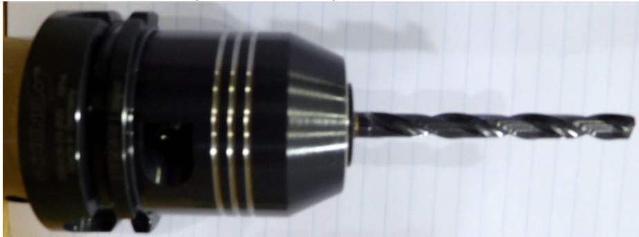
Obrázek 35 – Šroubovité vrták o \varnothing 7,8 upnutý v hydroupínači.
