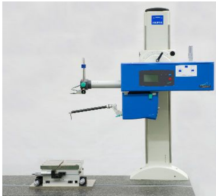
Obrázek 30 – Drsnoměr Hommel Etamic T8000. [22]
