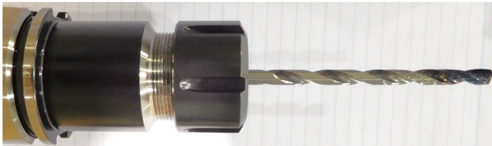
Obrázek 36 – Šroubovité vrták o \varnothing 7,1 upnutý do kleštiny.
