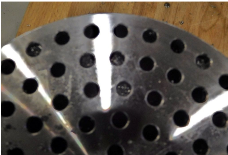
Obrázek 65 – Vlnité šroubovitě třísky zůstávající napěchované v díře.
