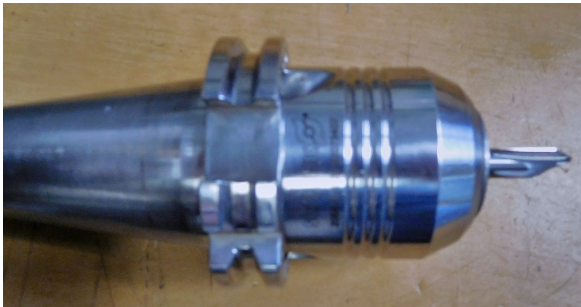
Obrázek 69 – Ukroucený cirkonový výstružník.
