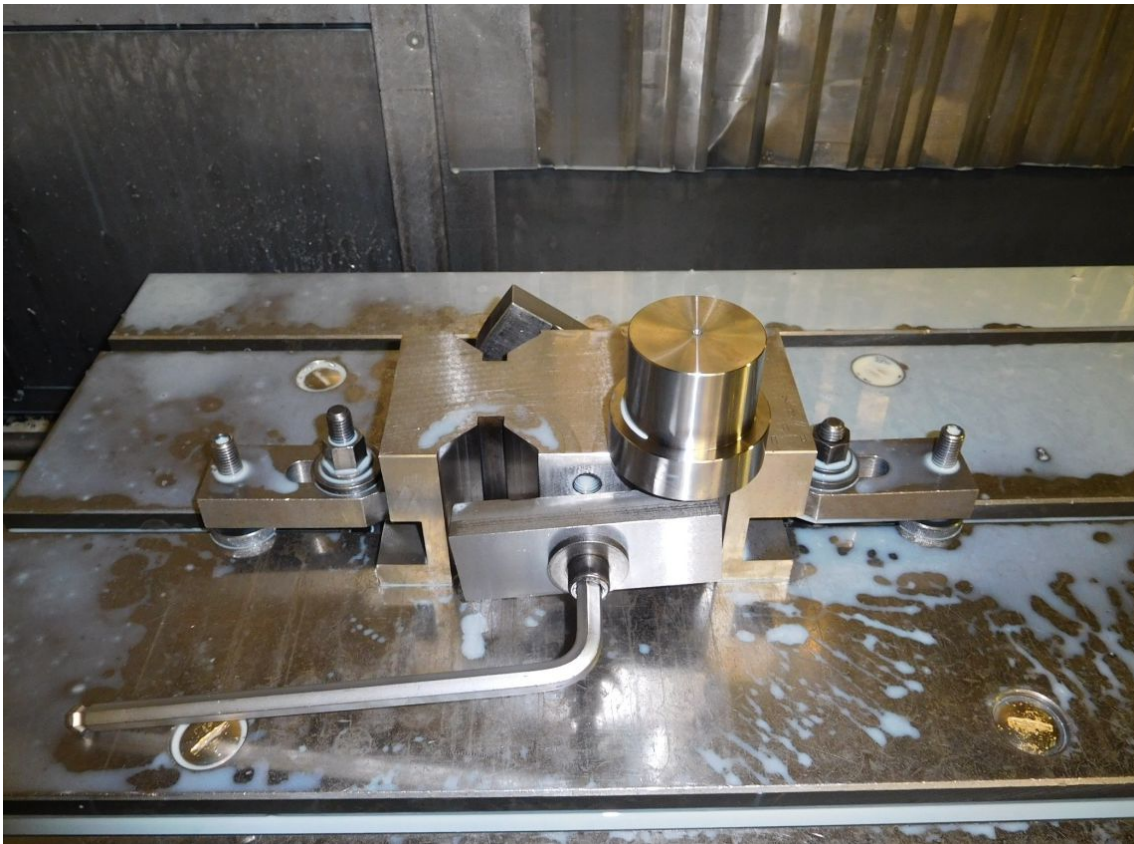
Obrázek 68 – Upnutí obrobku ve firmě Hofmeister.
